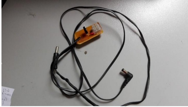
Figura 5 Regulador de voltaje con las salidas para la conexión de energía de cada módulo
